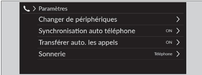
**Changer de périphériques** : appaire un nouveau téléphone au système et connecte, déconnecte ou supprime un appareil jumelé.
