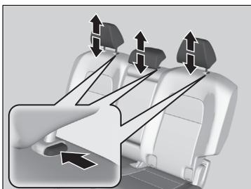
Un passager assis sur le siège arrière doit régler son appuie-tête à la hauteur voulue avant le démarrage du véhicule.
