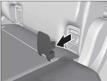
1. Localiser les points d'ancrage inférieurs sous les caches.
