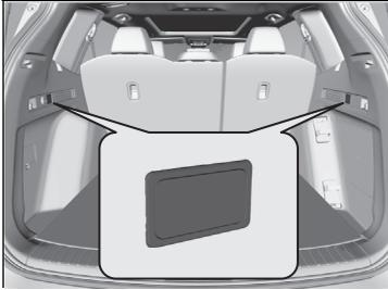
L'éclairage du compartiment à bagages s'allume lorsque le hayon s'ouvre.
