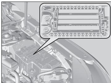
4. Contrôler les fusibles combinés installés dans la boîte à fusibles du compartiment moteur.
