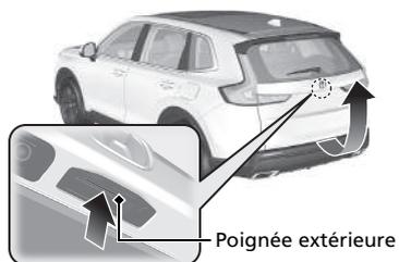
A l'aide de la télécommande d'accès sans clé, lever et abaisser le pied (en faisant un mouvement de coup de pied) sous le centre du pare-chocs arrière pour ouvrir ou fermer le hayon.
