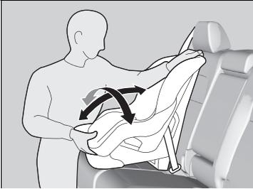
7. S'assurer que le dispositif de retenue pour enfant est fermement maintenu en le faisant basculer d'avant en arrière et d'un côté à l'autre ; il ne doit présenter que peu de jeu.
