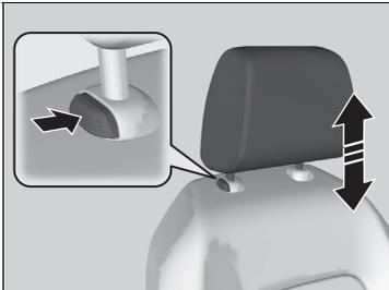
Les appuie-têtes sont très efficaces pour protéger contre le coup du lapin et autres blessures dues à une collision arrière lorsque le centre de l'arrière de la tête de l'occupant repose contre le centre de l'appuie-tête. Le haut des oreilles de l'occupant doit être au même niveau que la hauteur du centre de l'appuie-tête.
