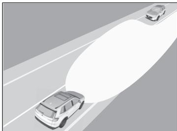
Lors de la conduite de nuit, la caméra à capteur avant détecte des sources lumineuses telles que les lampadaires ou les feux d'un véhicule venant en sens inverse/qui précède. En fonction de la situation, le système bascule automatiquement entre feux de croisement et feux de route.
