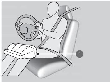
1 Déploiement de l'airbag de genoux côté conducteur
