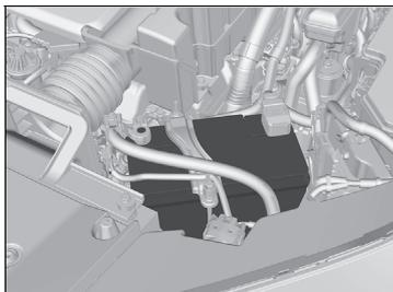
L'état de la batterie est contrôlé par un capteur situé sur la borne négative de la batterie. En cas de problème avec ce capteur, l'interface d'information du conducteur affichera un message d'avertissement. Dans ce cas, faire inspecter le véhicule par un concessionnaire.
