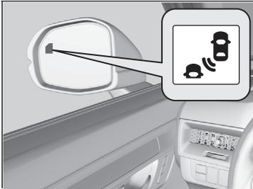
Lorsque les conditions suivantes sont remplies et que vous effectuez un changement de voie présentant un risque de collision avec un véhicule dans la voie adjacente approchant par l'arrière, le témoin du système anticollision latérale clignote, des alertes sonores et visuelles sont émises et le système agit sur la direction pour éviter les collisions.
