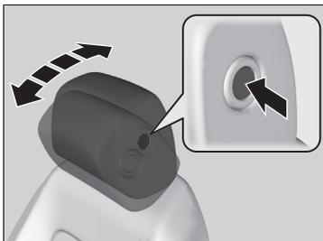
L'inclinaison de l'appuie-tête avant peut être réglée en fonction de la position de la tête du conducteur et du passager avant.
