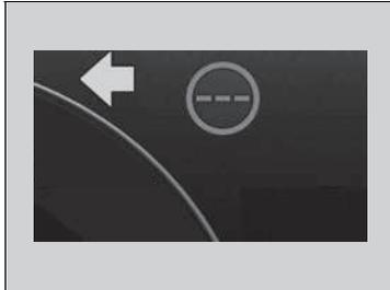
Si le système ne détecte pas les panneaux de signalisation pendant la conduite, le symbole
