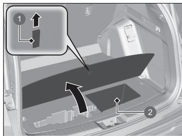
Tirer la poignée du couvercle de plancher et ouvrir le couvercle.
