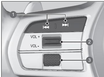
Permet de commander le système audio en conduisant. L'information est affichée sur l'interface d'information du conducteur.
