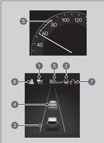
Il est possible de voir l'état actuel du régulateur de vitesse adaptatif (ACC) avec suivi à basse vitesse, du système d'assistance au maintien dans la voie de circulation (LKAS), de l'assistance embouteillages et de l'assistance active au changement de voie\*.
