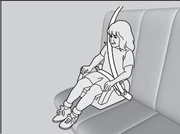
Si l'utilisation d'une ceinture de sécurité ventrale/thoracique ne convient pas, placer l'enfant dans un siège rehausseur sur le siège arrière. Pour la sécurité de l'enfant, s'assurer que ce dernier satisfait à l'ensemble des conditions du fabricant du siège rehausseur.
