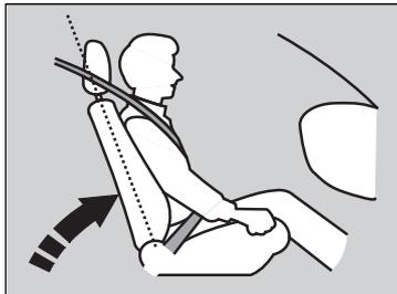
Régler le dossier du siège conducteur à une position confortable et bien droite, tout en laissant suffisamment d'espace entre le thorax et le cache de l'airbag se trouvant dans le volant.
