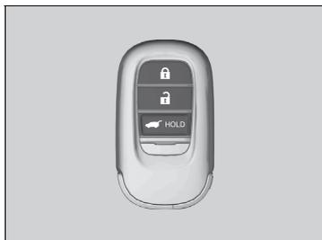
Utiliser les clés pour activer et désactiver le système d'alimentation, ainsi que pour verrouiller et déverrouiller toutes les portes, le hayon et la trappe à carburant.
