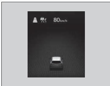
Votre véhicule reste à la vitesse réglée sans maintien du pied sur la pédale de frein ou d'accélérateur. Si auparavant, un véhicule détecté devant vous empêchait votre véhicule de rouler à la vitesse réglée, l'ACC avec maintien de distance de sécurité à basse vitesse fait accélérer votre véhicule jusqu'à la vitesse programmée, puis maintient cette vitesse.
