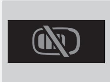
Lorsque le mode d'alimentation est sur un mode autre que DESACTIVE, que la télécommande d'accès sans clé est retirée du véhicule et que la porte est fermée, une alarme retentit. Si l'alarme continue à retentir, placer la télécommande sans clé à un autre emplacement.
