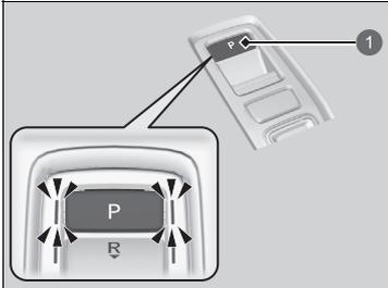
Le rapport passe en position **P** lors d'une pression sur la touche **P** alors que le véhicule est stationné avec le mode d'alimentation sur ACTIVE. Les indicateurs sur les côtés du bouton **P** s'allument.
