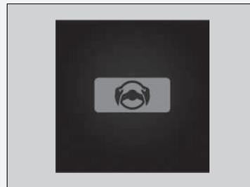
Si le conducteur n'agit pas sur le volant après l'affichage répété de l'avertissement ci-dessus, un signal sonore retentit et le système d'assistance embouteillages est désactivé.
