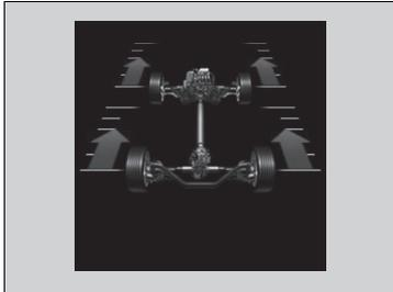
Les témoins sur l'écran indiquent la quantité de couple transmis aux roues avant droite, avant gauche, arrière droite et arrière gauche.
