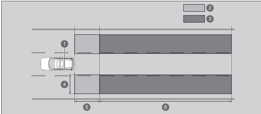
① Capteurs radar : sous les coins du pare-chocs arrière
