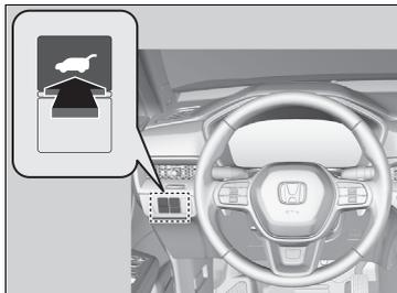
Pour ouvrir ou fermer le hayon électrique, appuyer sur le bouton du hayon électrique pendant environ une seconde.
