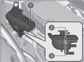
1. Vérifier le niveau de liquide de refroidissement dans le réservoir.
