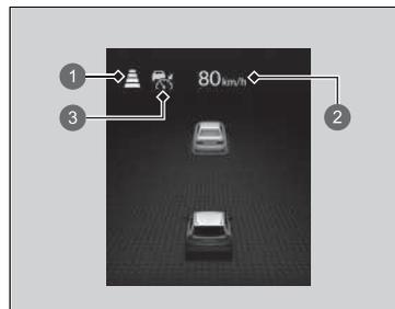
Lorsque l'ACC avec maintien de distance de sécurité à basse vitesse démarre, l'icône du véhicule, les barres d'intervalles et la vitesse réglée s'affichent sur la jauge.
