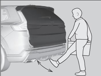
Effectuer un mouvement de coup de pied pendant 1 seconde sous le centre du pare-chocs arrière pour ouvrir ou fermer le hayon électrique en portant la télécommande d'accès sans clé sur soi.
