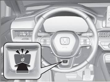
Le volant chauffant peut être utilisé lorsque le mode d'alimentation est ACTIVE.
