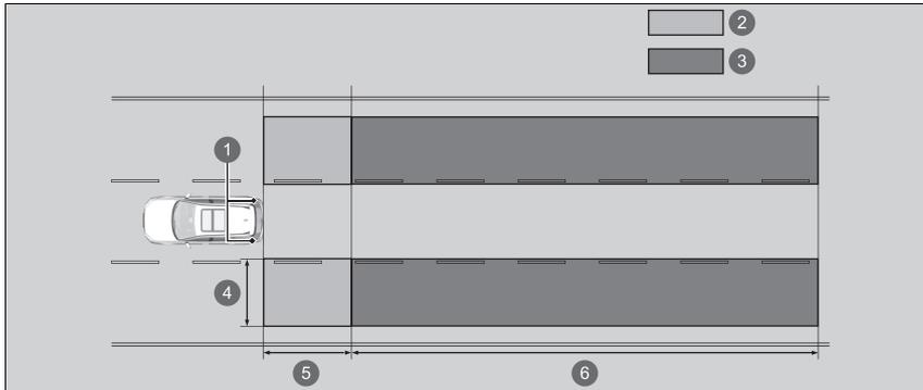
1 Capteurs radar : sous les coins du pare-chocs arrière
