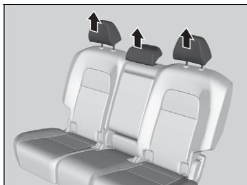
1. Déposer l'appuie-tête du siège arrière.
