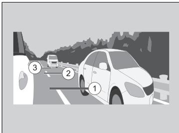
Trois lignes apparaissent sur l'écran pour donner une idée des distances respectives entre votre véhicule et les véhicules ou objets affichés à l'écran. Si un objet est proche de la ligne ① (en rouge), cela signifie qu'il est proche de votre véhicule, alors que s'il est proche de la ligne ③, il est plus éloigné de votre véhicule.
