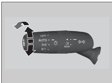
Les feux extérieurs s'allument automatiquement quand le commutateur d'éclairage est réglé sur **AUTO** tandis que le mode d'alimentation est activé.
