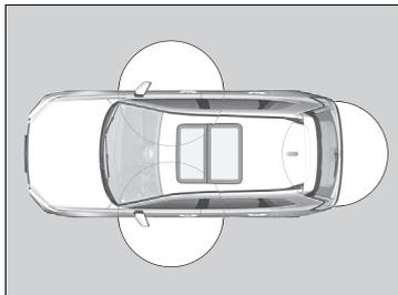
Lorsqu'on porte sur soi la télécommande d'accès sans clé, il est possible de verrouiller ou déverrouiller les portes, le hayon et la trappe à carburant. Les portes, le hayon et la trappe à carburant peuvent être verrouillés/déverrouillés dans un rayon d'environ 80 cm de la poignée de porte extérieure ou de la poignée extérieure du hayon.
