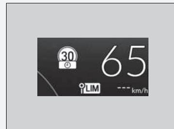
■ **Lorsque le système de reconnaissance des panneaux de signalisation (TSR) détecte le panneau de signalisation de limite de vitesse alors que le limiteur de vitesse intelligent est mis en pause**
