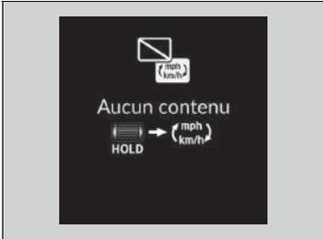
Permet d'afficher une autre unité sur l'interface d'information du conducteur, l'affichage tête haute et l'écran Audio/Informations et de régler les mesures affichées pour les lire en km et km/h ou en miles et mph.
