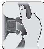
Lorsque le levier de vitesse se trouve sur la position **D**, le niveau de décélération apparaît.
