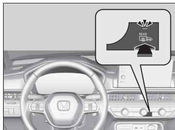
Appuyer sur la touche du désembueur arrière et du rétroviseur chauffant pour désembuer la vitre arrière et les rétroviseurs lorsque le mode d'alimentation est sur ACTIVE.
