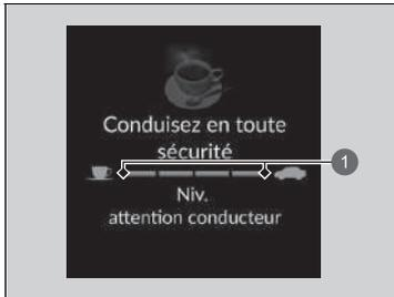
Lorsque l'option Moniteur attention conducteur est sélectionnée sur l'interface d'information du conducteur, des barres s'allument en blanc pour indiquer le degré d'attention du conducteur.
