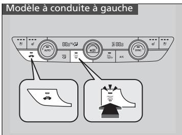
Une pression sur la touche
