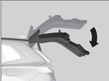
La plage d'ouverture automatique du hayon électrique peut être programmée.
